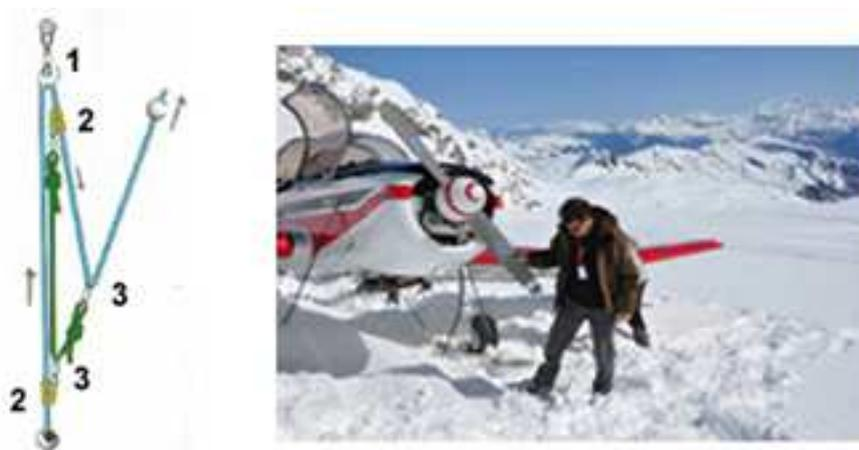
Il nécessite outre la poulie principale à bloqueur [1] un bout de cordelette en plus (en vert sur la figure), 2 blocages sur la corde principale (nœuds Machards ou tibloks [2]) et 2 poulies [3].
